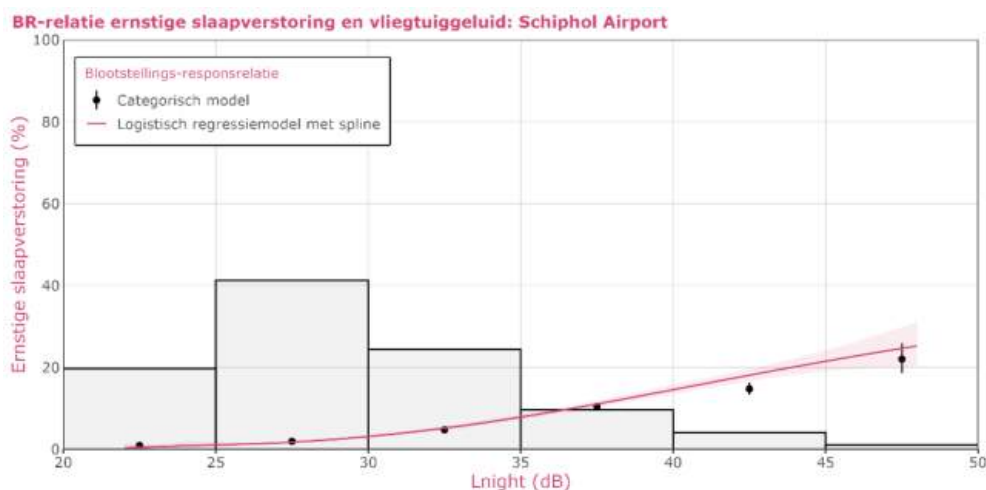
Figuur 4.2 Blootstelling-responsrelatie (BR-relatie) tussen ernstige slaapverstoring en blootstelling aan vliegtuiggeluid ( L_{night} , berekend met het Doc29- rekenmodel) rondom Schiphol Airport.
